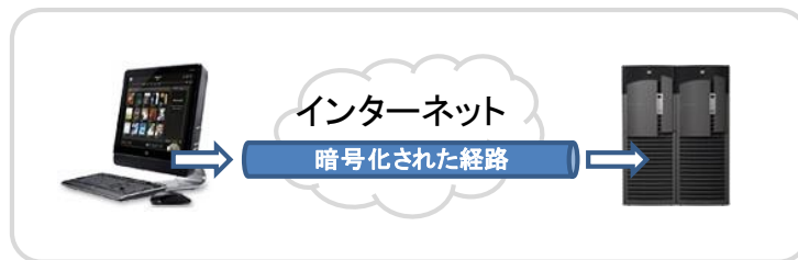
図 1 : SSH 暗号化経路概念図
