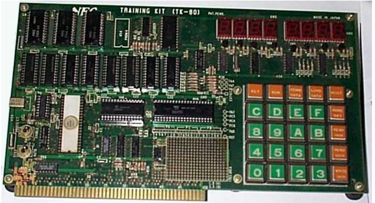
CPU はインテル 8080 互換の \mu PD8080A 2MHz / 1KByte Memory
