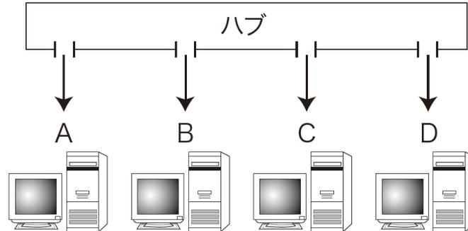
例えば、あるハブに A、B、C、D の4台のマシンが接続されていたとして、マシン A に届くべきパケットは、ハブを経由してマシン B、C、D にも届いて\*6しまいます。その上で、それぞれのマシンはパケットのヘッダに書いてある宛先を見、自分が宛先でないと判断するとパケットを破棄するのです。
