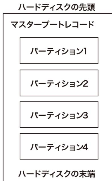
上図はパーティション分けされたハードディスクの模式図で、ハードディスクの先頭にマスターブートレコード(MBR)と呼ばれる領域があることを示しています。MBRにはパーティションの位置情報とOSを起動するためのプログラム(ブートローダ)が収められています。
